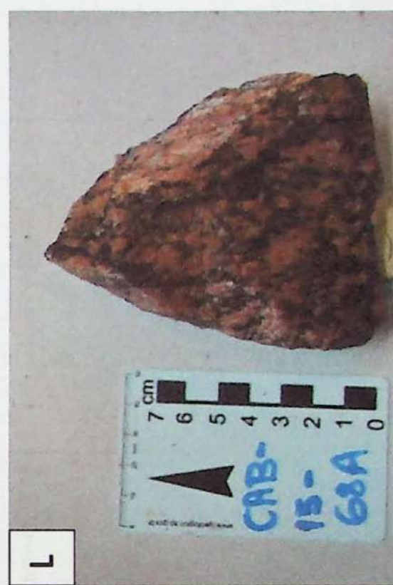
I) CAB-15-49: granito equigranular J) CAB-15-62A: sienogranito deformado K) CAB-15-62B: sienogranito deformado (alterado) L) CAB-15-68A: granito deformado
