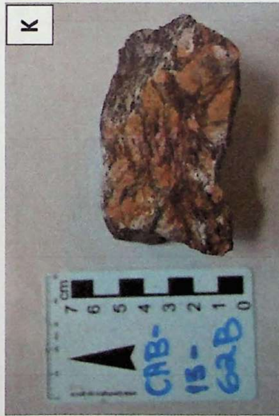
I) CAB-15-49: granito equigranular J) CAB-15-62A: sienogranito deformado K) CAB-15-62B: sienogranito deformado (alterado) L) CAB-15-68A: granito deformado
