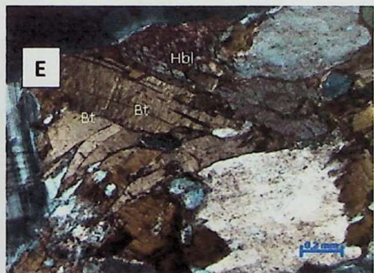
Figura 11. Fotomicrografias do monzogranito do ponto CAB-15-49: a) textura xenomórfica equigranular. Notar a alteração do plagioclásio (polarizadores paralelos) e; b) com os polarizadores cruzados; c) piroxênio anédrico (polarizadores cruzados); d) clinopiroxênio parcialmente substituído por hornblenda (polarizadores paralelos); e) hornblenda (seção basal) com bordas substituídas por biotita (polarizadores cruzados); f) biotita acastanhada anédrica com bordas substituídas por clorita (polarizadores paralelos).
