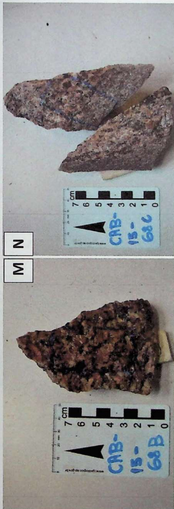
M) CAB-15-68B: granito deformado N) CAB-15-68C: granito deformado O) CAB-15-68C: granito deformado com dique aplitico
